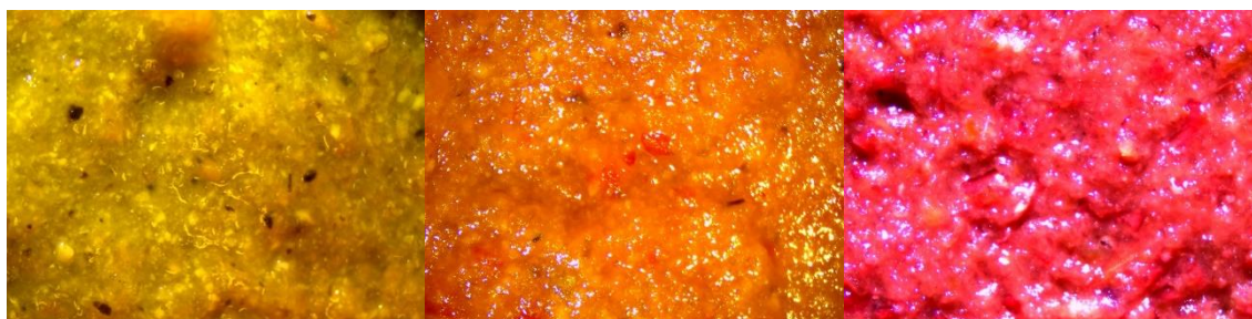
Ryc. 5. Mikrostruktura uzyskanych past (od lewej zielona, pomarańczowa, czerwona)
